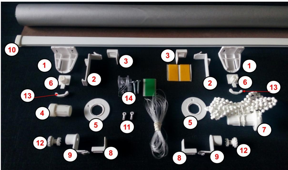
Vybalíme roletu a montážní díly z tuby. Rozbalíme vodící silon, rozvineme ho a ustříhneme na dvě stejně dlouhé části. Vezmeme boční díly číslo 1. Spodní dírkou (viz. foto) prostrčíme konec silonu a ze zadu uděláme uzel.
